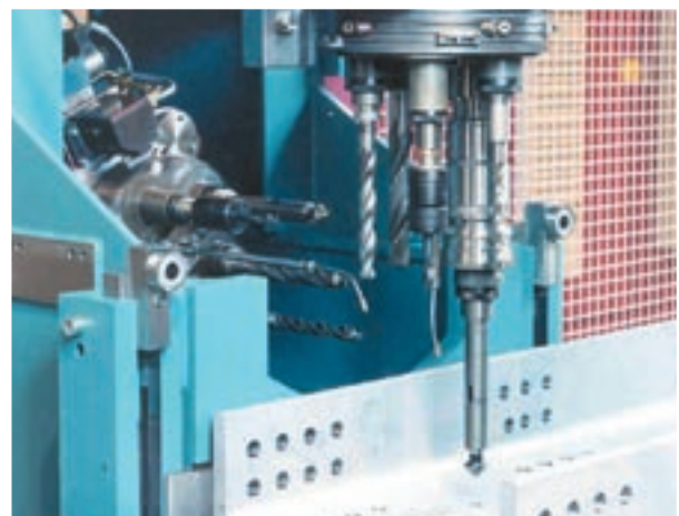
Ett hål eller flera? Vi borrar, gängar och gradar med precision i två plan från tre håll.
