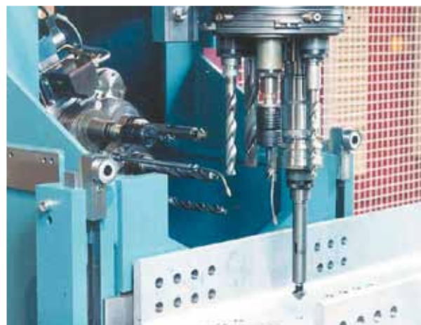
Ett hål eller flera? Vi borrar, gängar och gradar med precision i två plan från tre håll.
