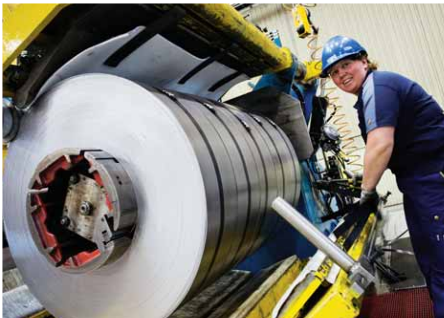
Tunnplåtsbolaget ArcelorMittal BE Group SSC AB noterar bättre ordergång än väntat efter semestrarna. Malin Hed laddar slittningsmaskinen med nya coils.
