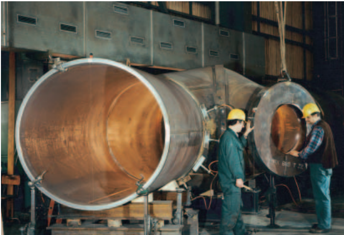
Kuva 7: DILLIMAX 690 teräksestä valmistettuja putkijohdon osia vesivoimaloiden turbiini-rengasjohtoja varten (Kuva julkaistu Sulzer Hydro Ltd, Zürich, Schweiz, yhtiön luvalla)
