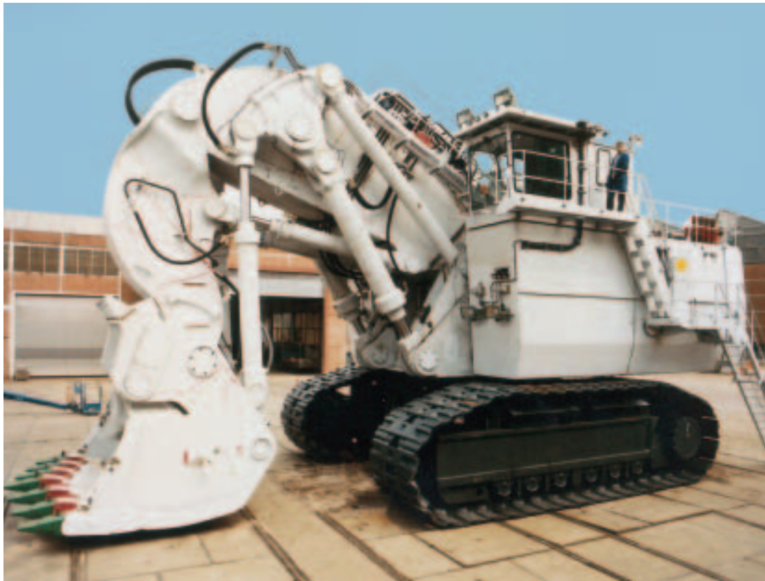
Kuva 4: O&K-hydraulikaivuri RH 400: kantavat rakenteet DILLIMAX 690 T terästä (kuva julkaistu Terex-O & K, Dortmund -yhtiön luvalla)
